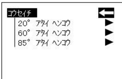
3角度測定機の場合には、角度の選択画面が表示されます。ご希望の角度を指定してスクロールホイールを押して下さい。
