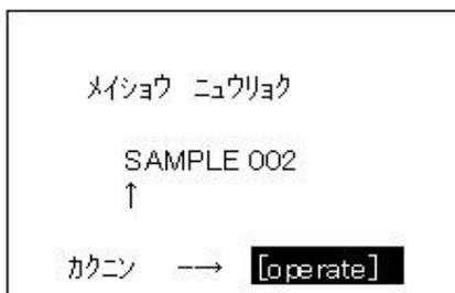
セーブモードが動作中の場合、新しい測定開始時にサンプル名入力項目が表示されます。
