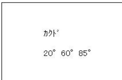
スクロールホイールで希望の測定角度を選択し、スクロールホイール(モード)を押して確定します。
